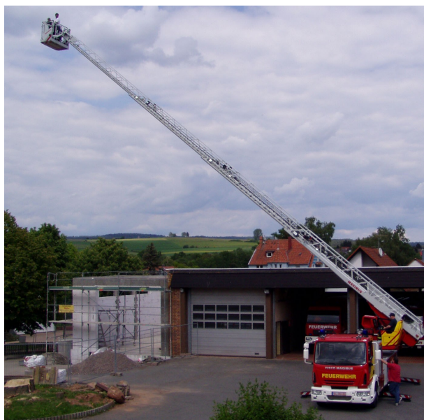
DLA (K) 18/12 von Iveco Magirus; im Hintergrund sieht man den Rohbau zur Erweiterung der Fahrzeughalle.
